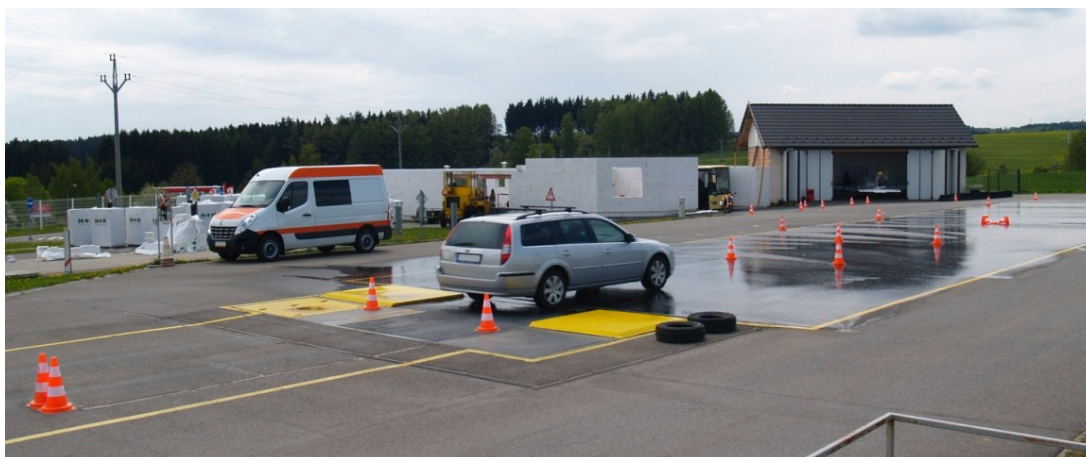
Obrázek 18: Zařízení pro nucený smyk zadní nápravy
