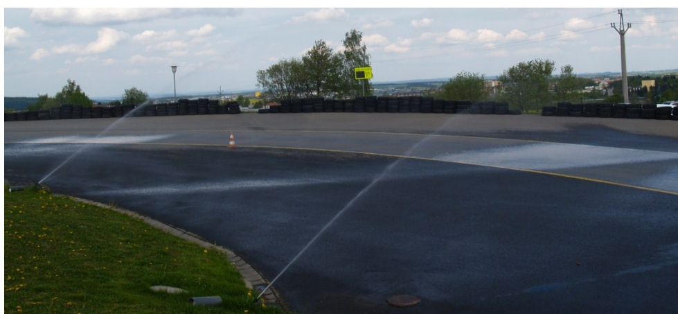
Obrázek 19: Zavlažovací zařízení a zařízení pro měření rychlosti
