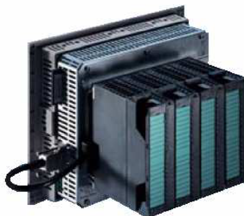
Obr. 8 Uspořádání modulů na hloubku
