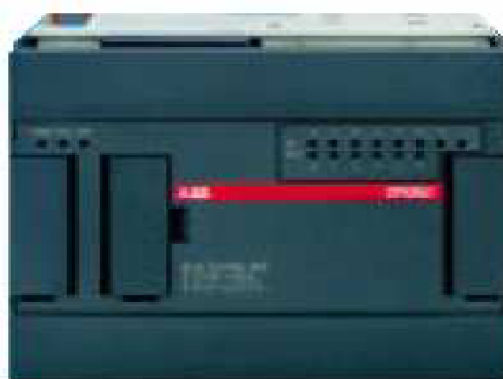
Obr. 2 Programovatelný automat AC31 série 40...50
