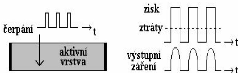
Obr. 22: Princip spínání zisku (převzato z [11])
