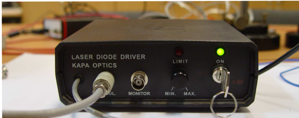
Obr. 35: Školní budič laserové diody
