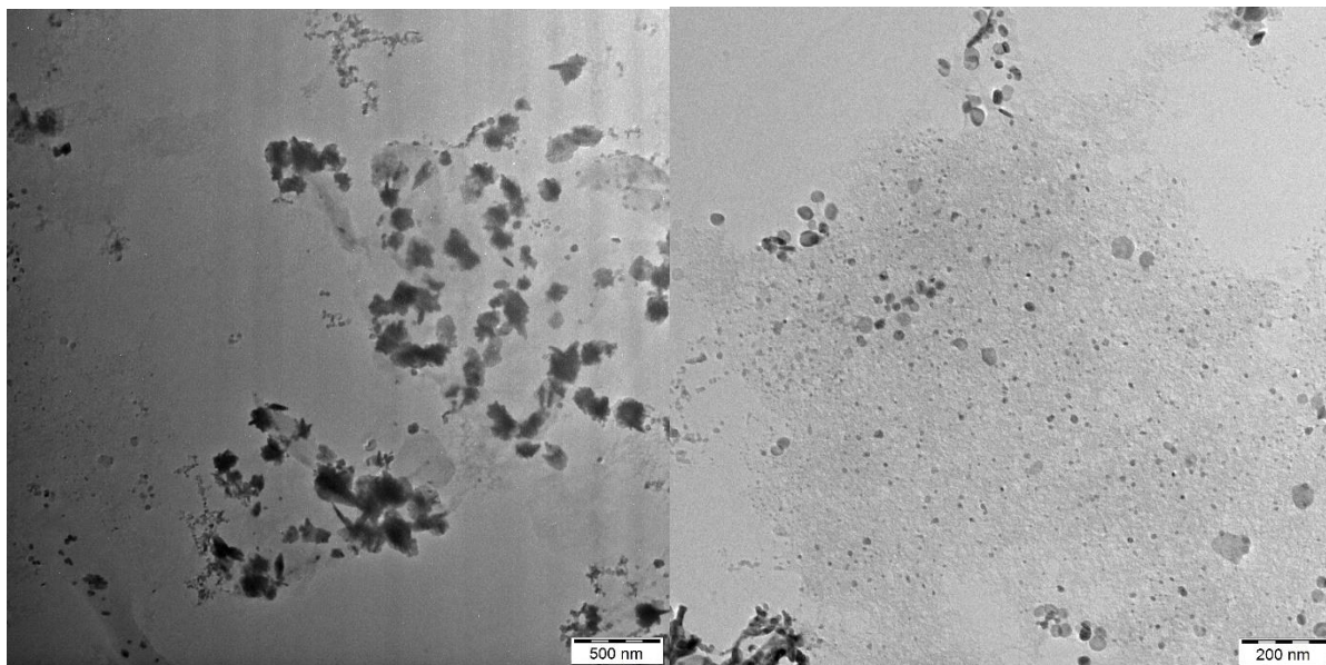
Obrázky 21 a 22: TEM snímky kompozitů připravených přímou redukcí při použití 1 ml citranu
