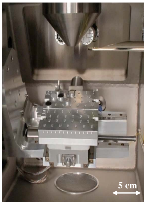
Obrázek 1.4: Pohled do vnitřku vakuové komory TESCAN XM. Pod objektiv (nahore) je možné zasunout detektor zpětně odražených elektronů (nahore vpravo) a vzorkem lze volně pohybovat pomocí čtyřosého manipulátoru (uprostřed). Převzato z [17].
