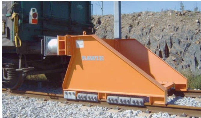
Obr. 5.9 Pohyblivé zarážedlo RAWIE, typ 10 EB [17]
