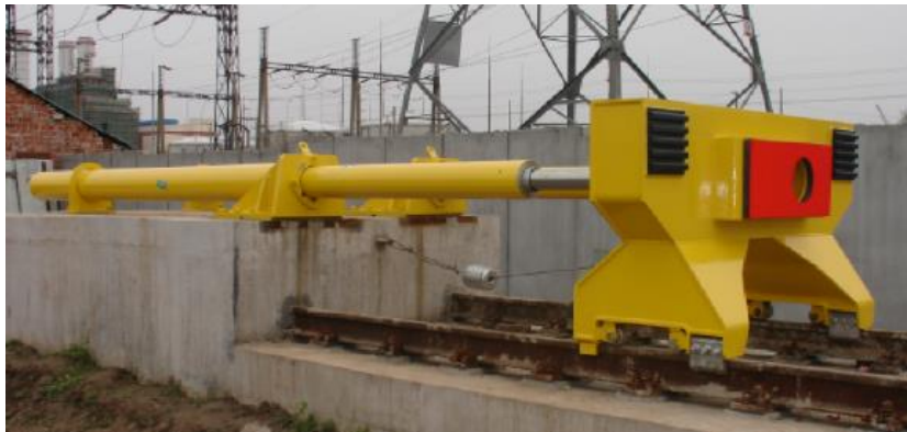
Obr. 5.5 Betonové hydraulické zarážedlo britské společnosti Oleo [16]
