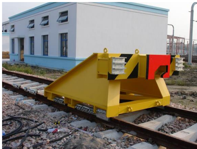
Obr. 5.10 Pohyblivé zarážedlo Oleo s přídavnými brzdami [16]
