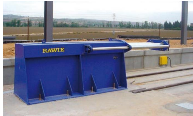
Obr. 5.4 Ocelové hydraulické zarážedlo německé firmy Rawie [17]
