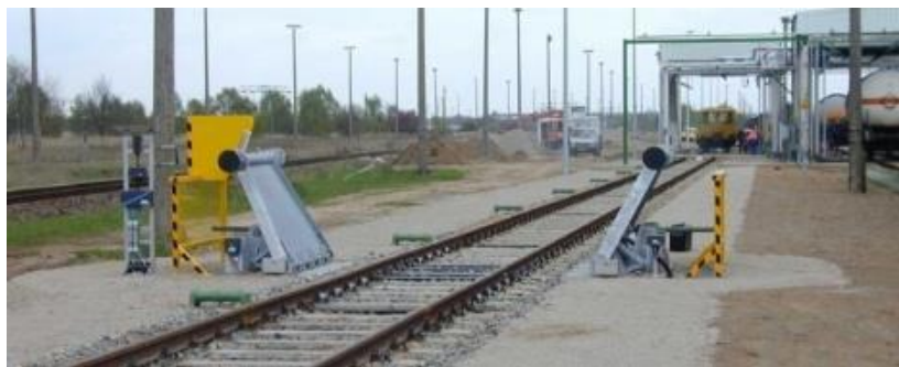
Obr. 5.13 Dočasné zarážedlo pevné po sklopení [17]
