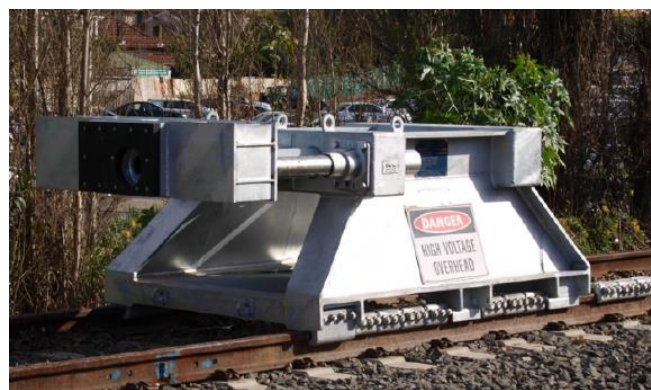
Obr. 5.11 Pohyblivé hydraulické zarážedlo s hydraulickými nárazníky OLEO [16]
