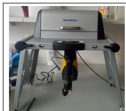
(Obr. č. 11: Zařízení s XRF spektrofotometrem)
