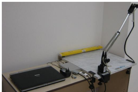
Obrázek 6. Polohový snímač, základní deska, elektronická vyhodnocovací jednotka, osobní počítač (fotoarchiv autorky, 2015)
