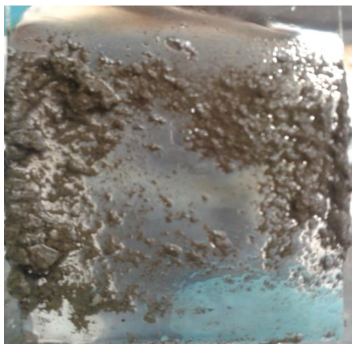
Obr. 42: Mikroskopické sklíčko s vrstvou stříbra, původní koncentrace
