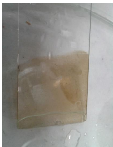
Obr. 43: Mikroskopické sklíčko s vrstvou stříbra, čtvrtinová koncentrace
