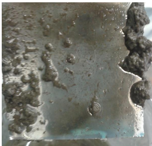
Obr. 39: Mikroskopické sklíčko s vrstvou stříbra, původní koncentrace
