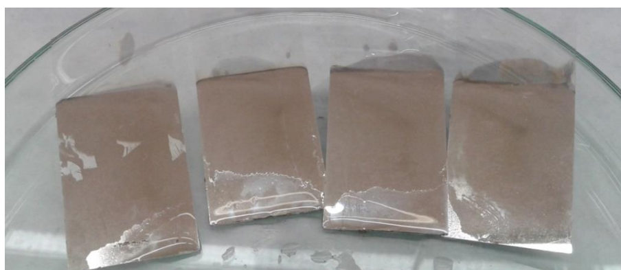
Obr. 44: Mikroskopická sklíčka s vrstvou stříbra, poloviční koncentrace, glukóza
