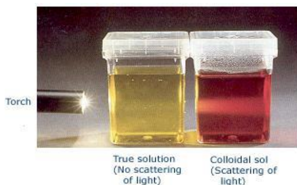
Obr. 2: Rozptyl světla v pravém roztoku (vlevo) a v koloidní disperzi (vpravo)
