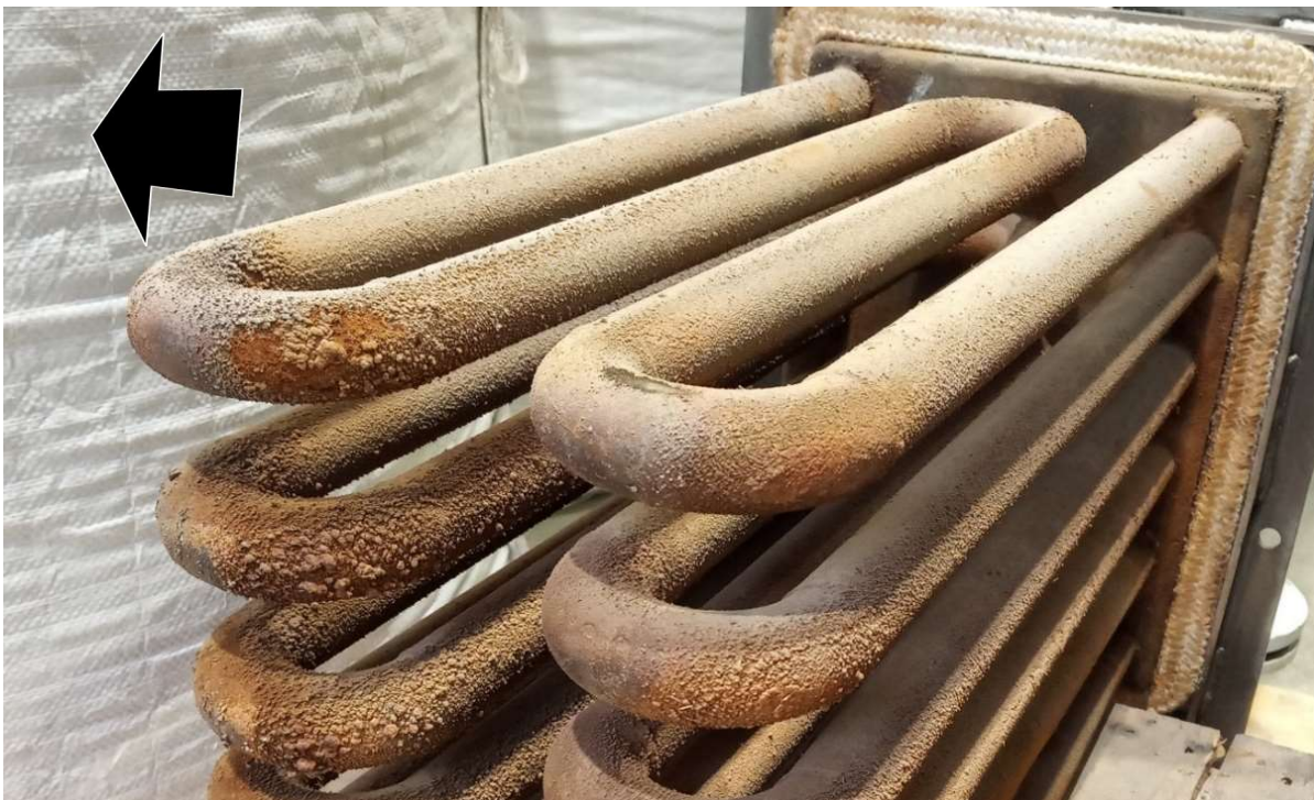
Obr. 52: Čtvrtý trubkový svazek. Šipka označuje směr proudu spalin.
