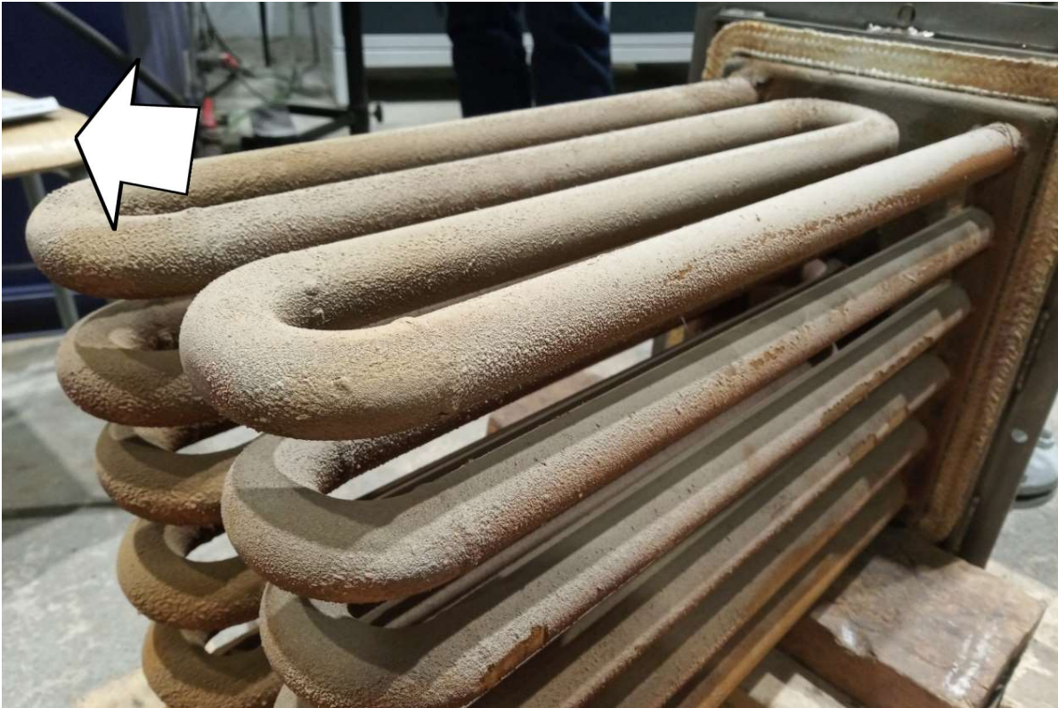
Obr. 51: Třetí trubkový svazek. Šipka označuje směr proudu spalin.
