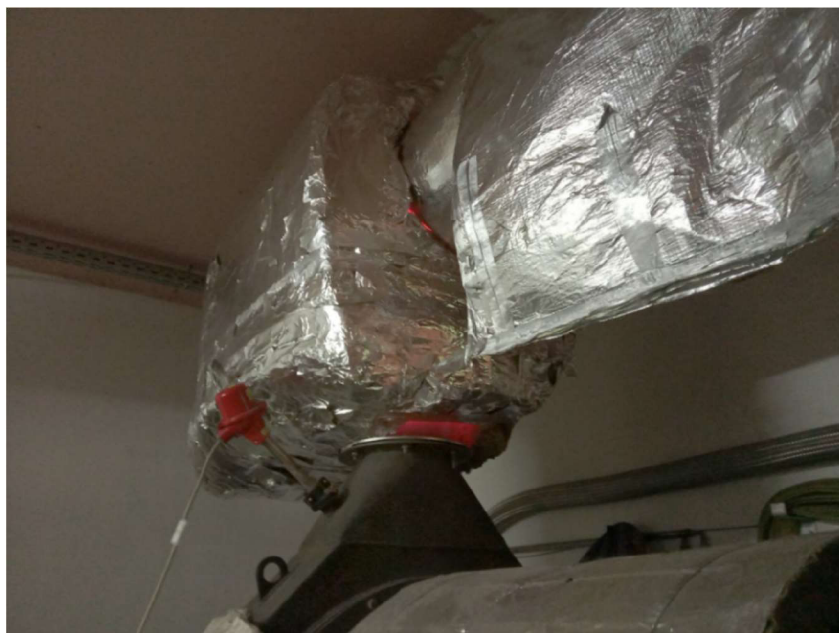
Obr. 8: Usazovací komora v průběhu spalovací zkoušky.
