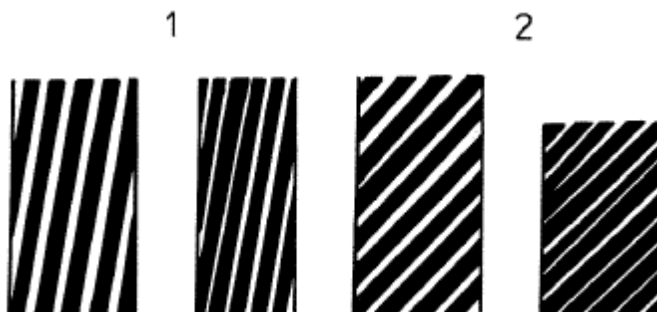
Obrázek 9 - Zmenšování rozměrů dřeva podél a napříč vláken při různém úhlu sklonu mikro fibril: 1 - podél vláken; 2 - napříč vláken; černé pásky - mikro fibrily; bílé pásky - vrstvičky vody Zdroj: Perelygin 1965
