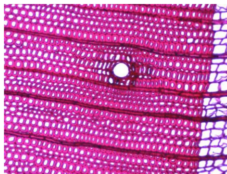
Obrázek 3 - Prykyřičný kanálek, přechod mezi jarním a letním dřevem Zdroj: URL4
