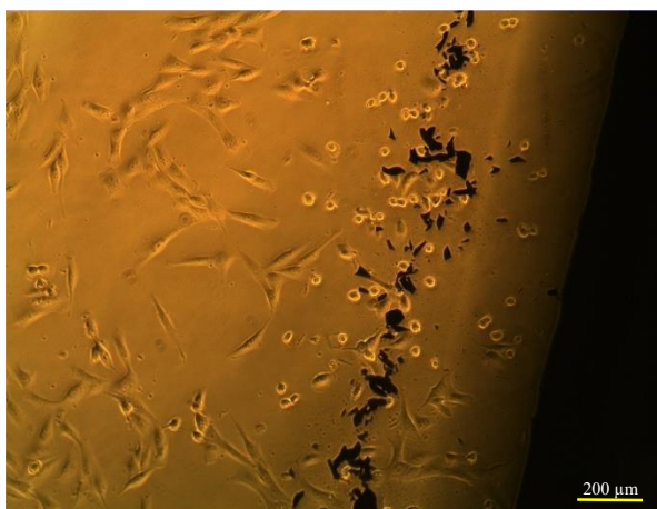
Obr. 4.46: Znázornění odlučování částic z povrchu u vrstvy s označením CrCN 8
