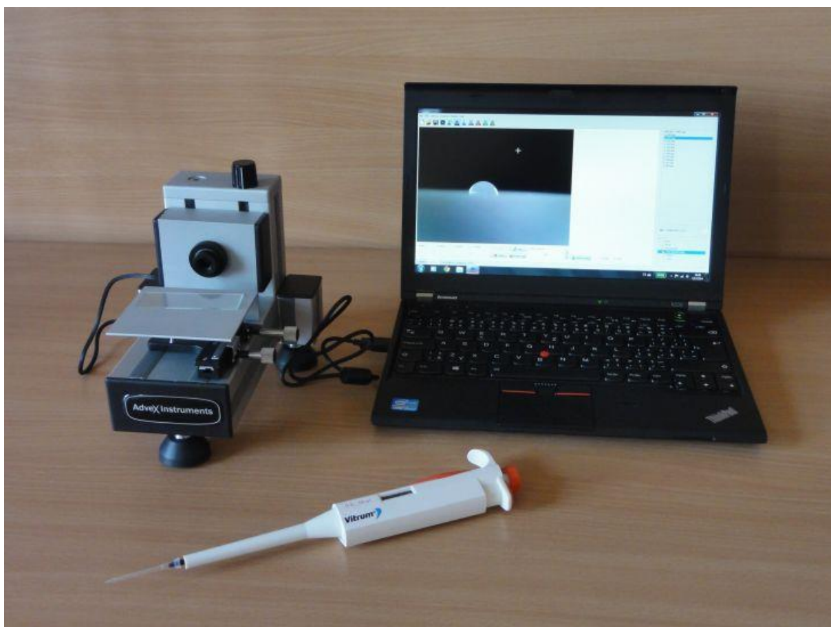
Obr. 3.9: Zařízení pro měření kontaktního úhlu a stanovení volné povrchové energie.
