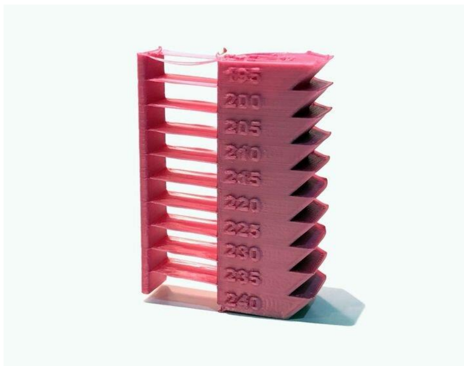
Obr. 2.11 Teplotní testovací věž znázorňující závislost daného materiálu na teplotě tisku [17].
