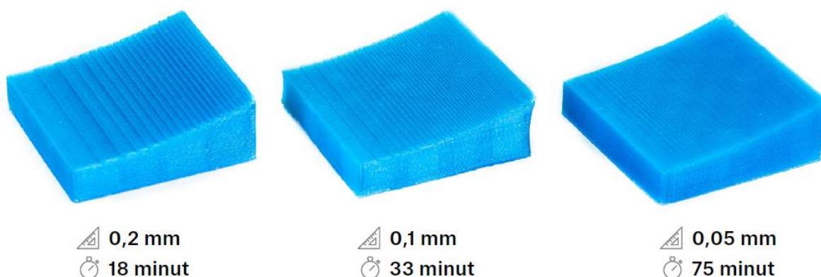
Obr. 2.7 Vliv tloušťky vrstvy na detail v rovině XY [4].
