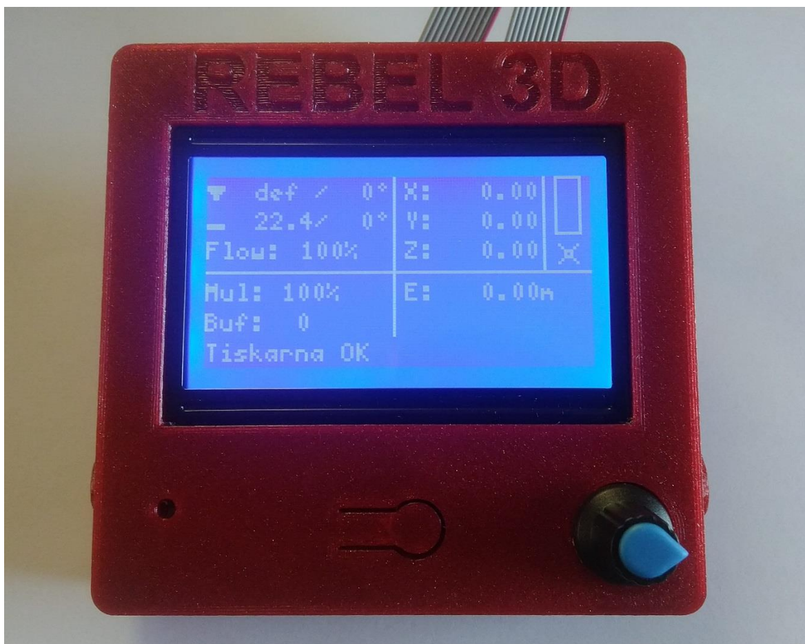
Obr. 3.14 Obrazovka 3D tiskárny s uživatelským prostředím firmwaru Repetier.
