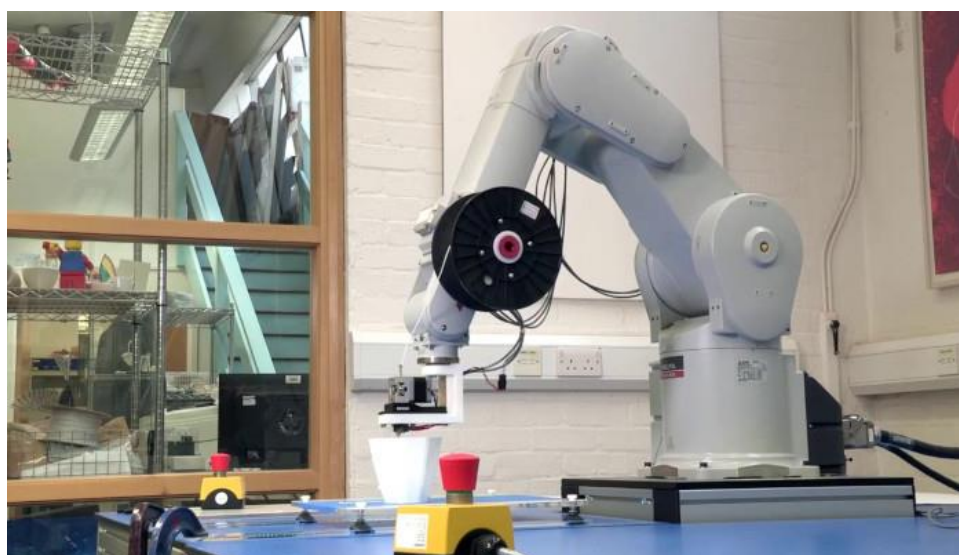
Obr. 2.19 Robotická paže v kombinaci s FDM 3D tiskem [23].
