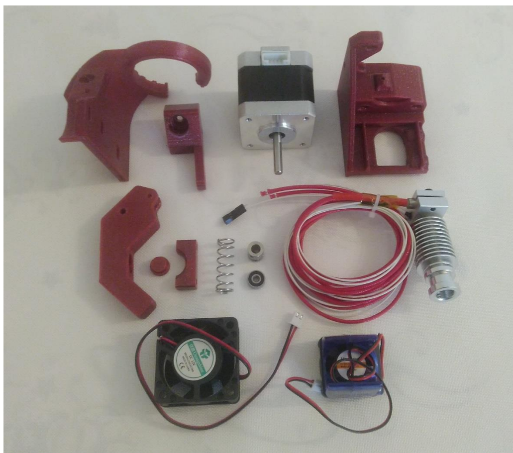
Obr. 4.14 Tisková hlava typu Rebel II před sestavením.
