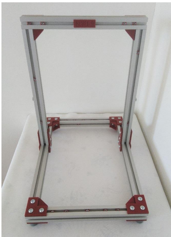
Obr. 3.9 Rám 3D tiskárny Rebel II sestavený z AL profilů a dílů zhotovených 3D tiskem.
