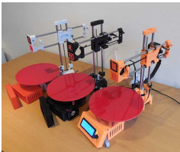
Obr. 2.18 3D tiskárny R-360 konstrukčního typu Polar [20].
