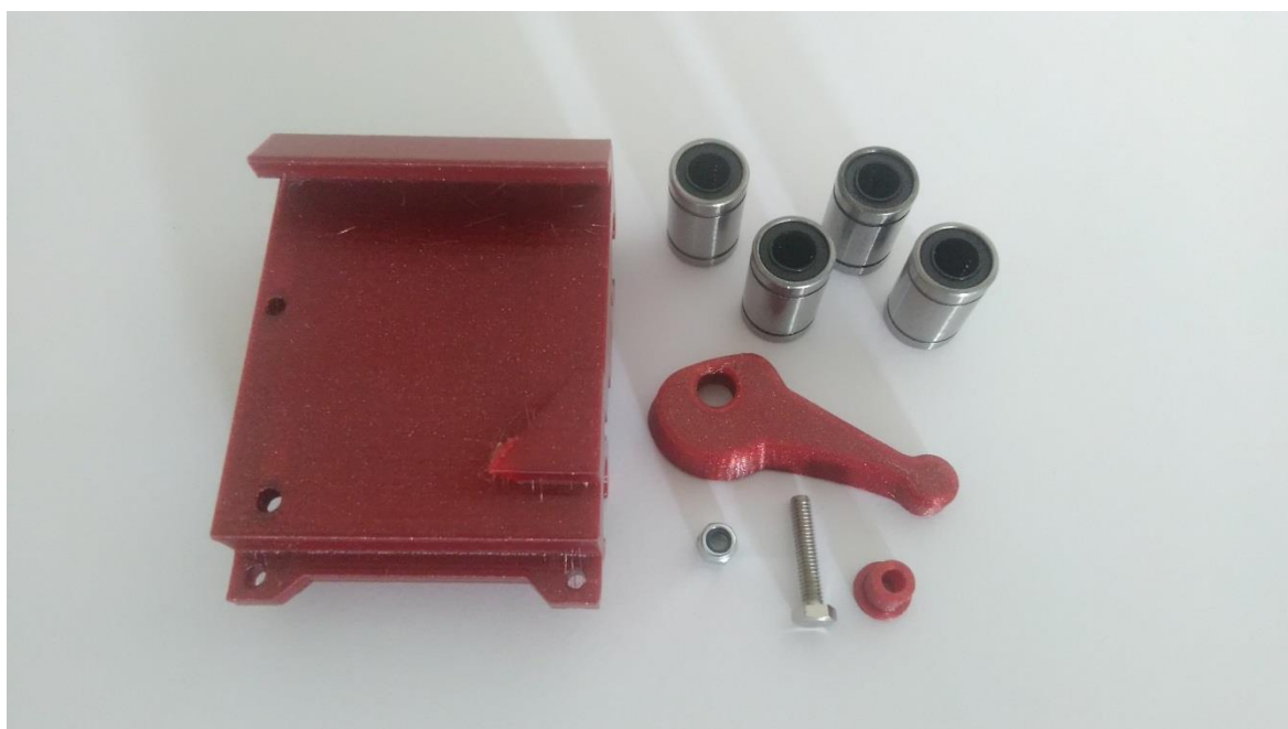
Obr. 4.12 Mechanismus výměnné hlavice před sestavením.
