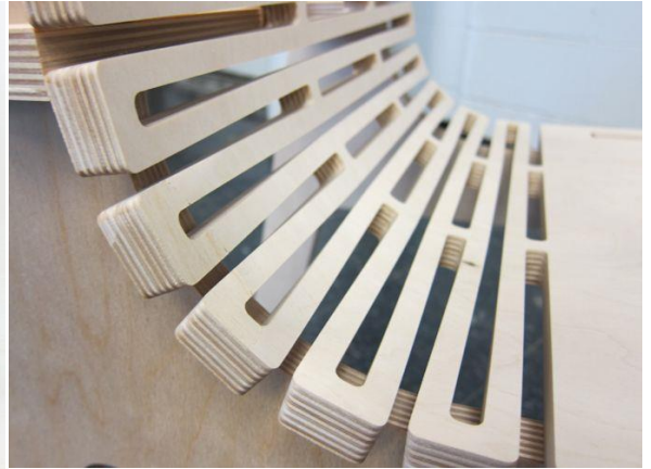
Obr. 70 - Pružná perforace u sedáku židle
