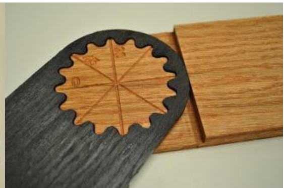
Obr. 72 - Polohovatelný spoj II
