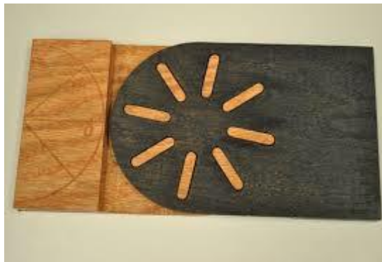
Obr. 71 - Polohovatelný spoj I
