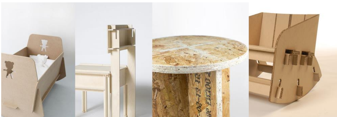
Obr. 47 - Materiály užitě v CNC nábytku. Zleva MDF, PDP, OSB, PAP
