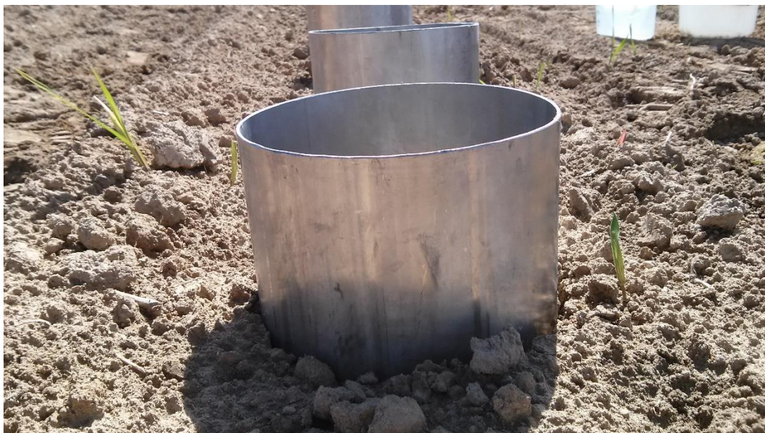
Obrázek 8 Válců pro měření infiltrace
