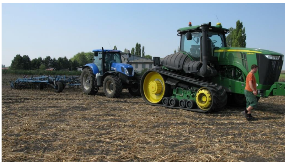
Obrázek 6 Souprava pro měření tahového odporu v roce 2015
