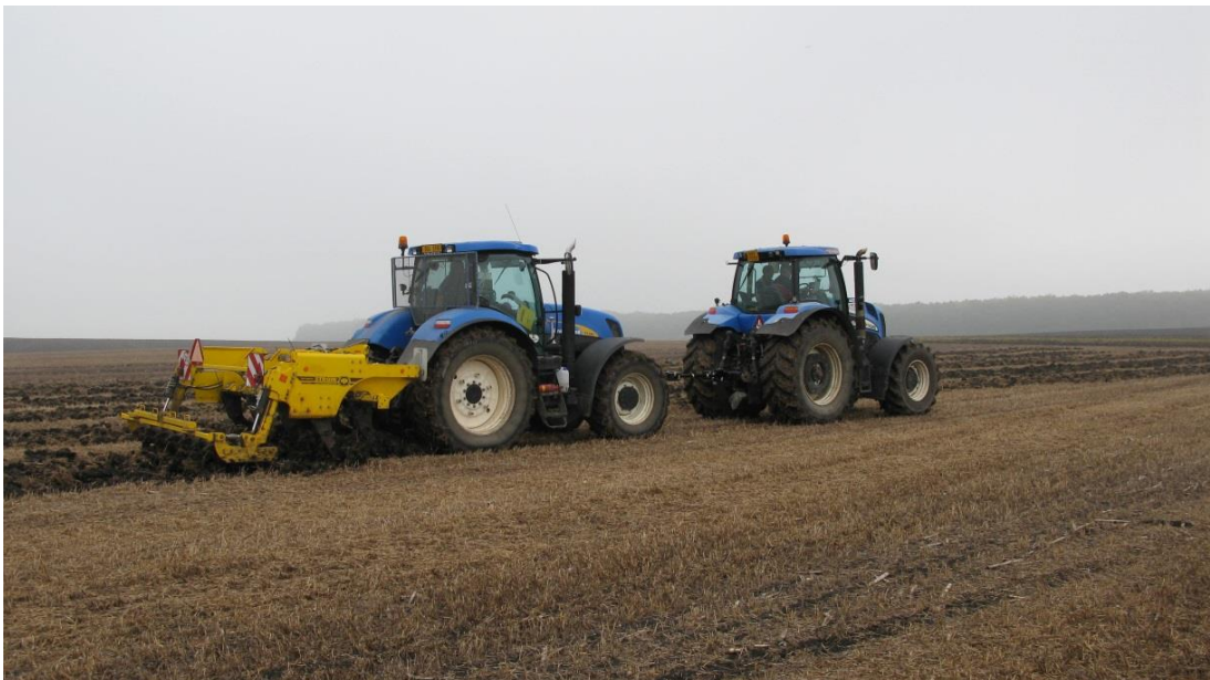
Obrázek 4 Souprava pro měření tahového odporu v roce 2014
