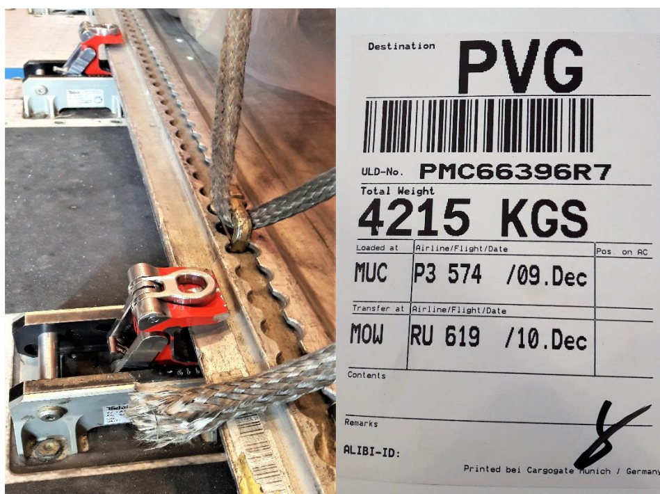
Obr. 6 Bezpečnostní jištění a paletový informační štítek
