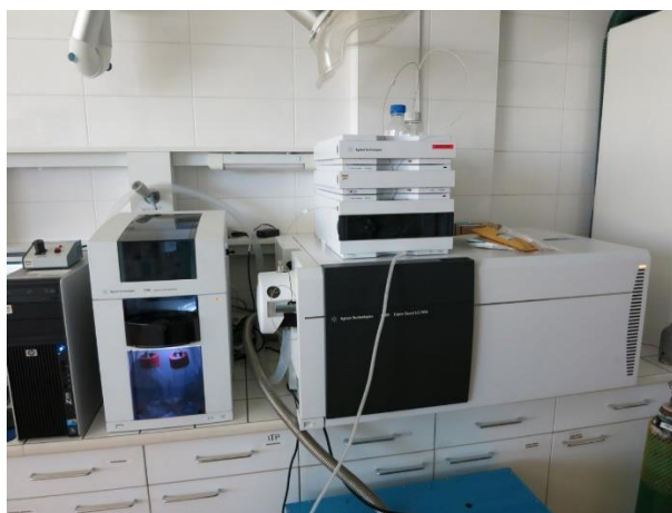
Obr. 24 Kapilární elektroforéza Agilent 7100 ve spojení s trojitým kvadrupólovým analyzátozem MS Agilent 6460. Převzato z [39]
