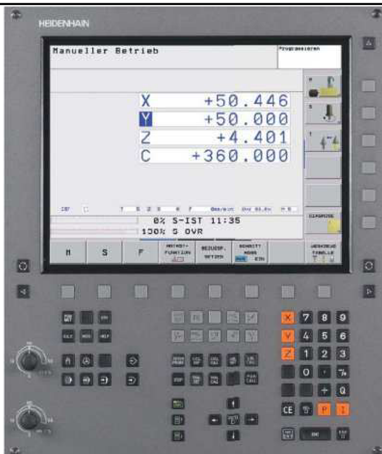
Obr. č. 8 Ovládací panel Heidenhain iTNC 530. [10]
