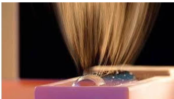
Obr. 24: Ohniská Taylorových kuželov – hlava Nanospideru TM . Prevzaté (34).
