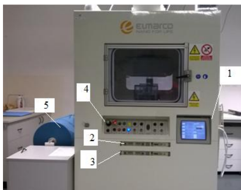
Obr. 25: Schéma zariadenia pre elektrostatické zvlákňovanie Nanospider TM .
