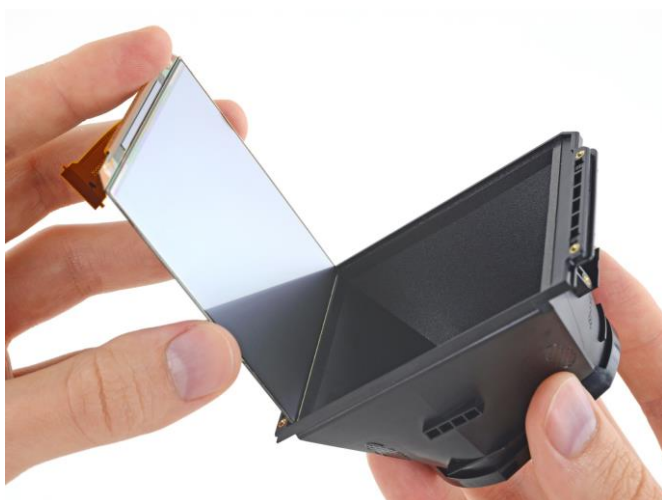
obr. 2-14 Displej určený jednomu oku v HTC VIVE [12]
