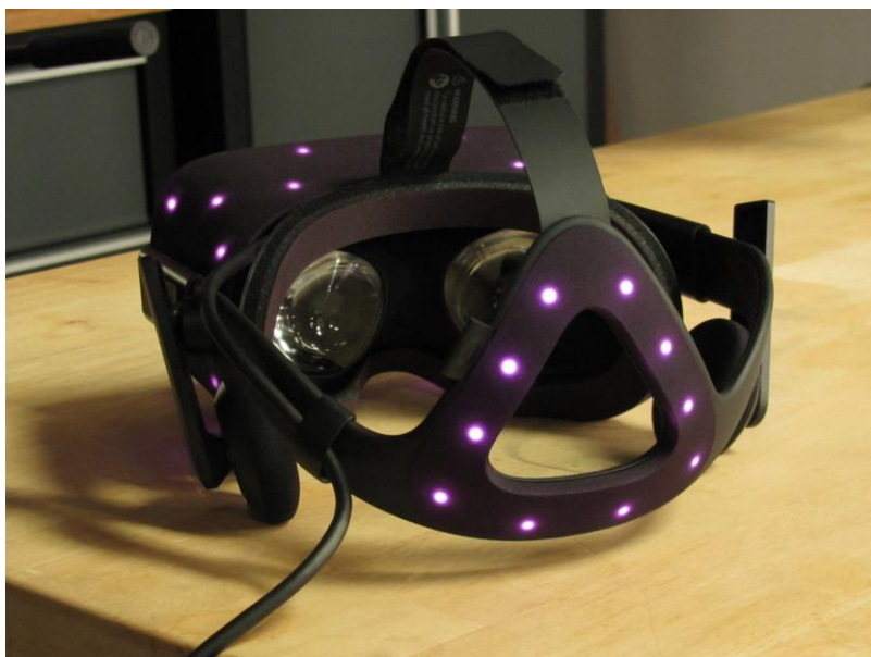
obr. 2-18 Constellation outside-in snímání, pohled IR kamerou [15]
