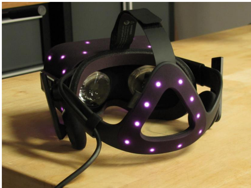
obr. 2-18 Constellation outside-in snímání, pohled IR kamerou [15]
