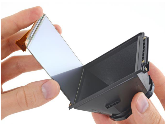
obr. 2-14 Displej určený jednomu oku v HTC VIVE [12]
