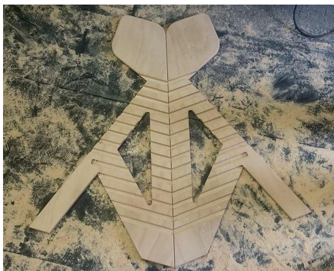
Obr. 29 Drážky na nohách židle Zdroj: Vlastní práce
