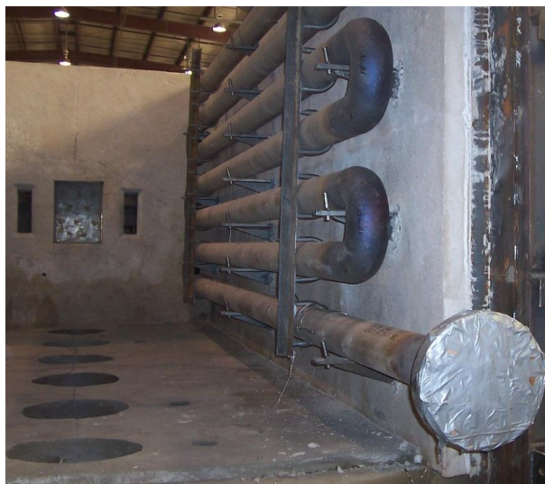
Obrázek 2: Pohled do nitra trubkové pece [5]
