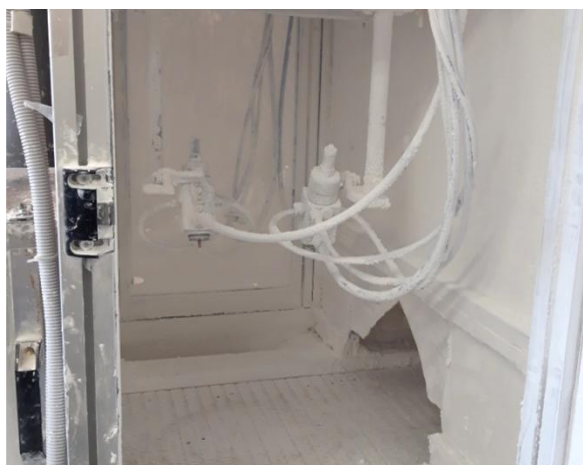
Obrázek 14 Trysky nanášející Paintflux na výrobek.
