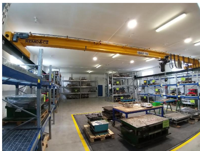
Obrázek 29 Mostový jeřáb REMO CZ 2,5t.
