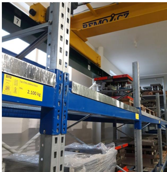
Obrázek 4 Regál ke skladování forem k lisu. V pozadí mostový jeřáb.
