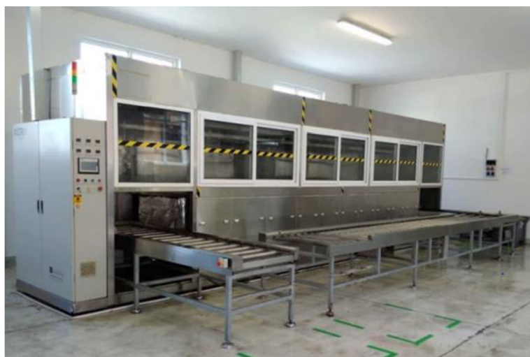
Obrázek 13 Přístroj na odmašťování výrobků.
