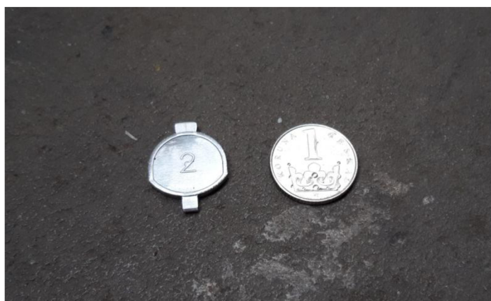
Obrázek 10 Baffle. Na porovnání velikosti vedle mince.
