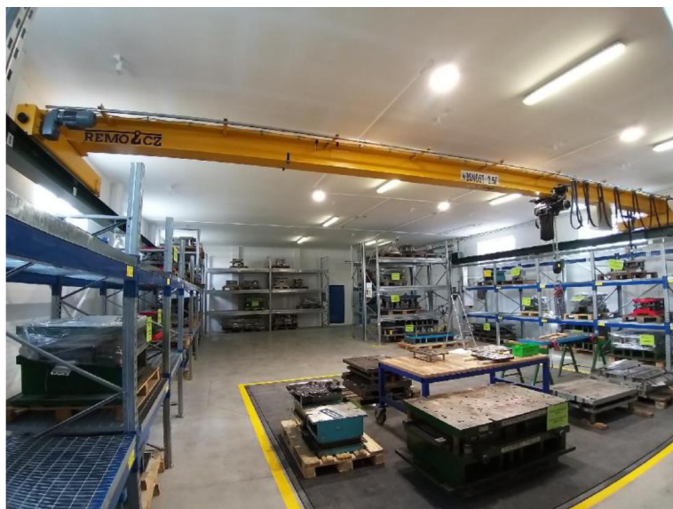
Obrázek 29 Mostový jeřáb REMO CZ 2,5t.
