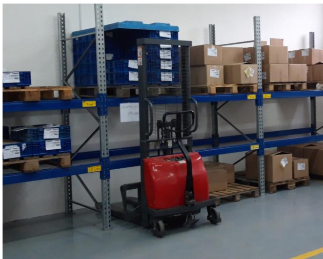
Obrázek 31 Ruční vysokozdvizný vozík EUROLIFT.
