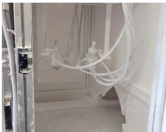
Obrázek 14 Trysky nanášející Paintflux na výrobek.
