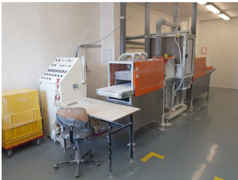
Obrázek 15 Přístroj na povrchovou úpravu - fluxování
