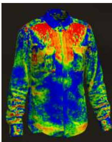
Obr.č. 37: Simulace padnutí oděvu z hlediska mechanických vlastností [24]
