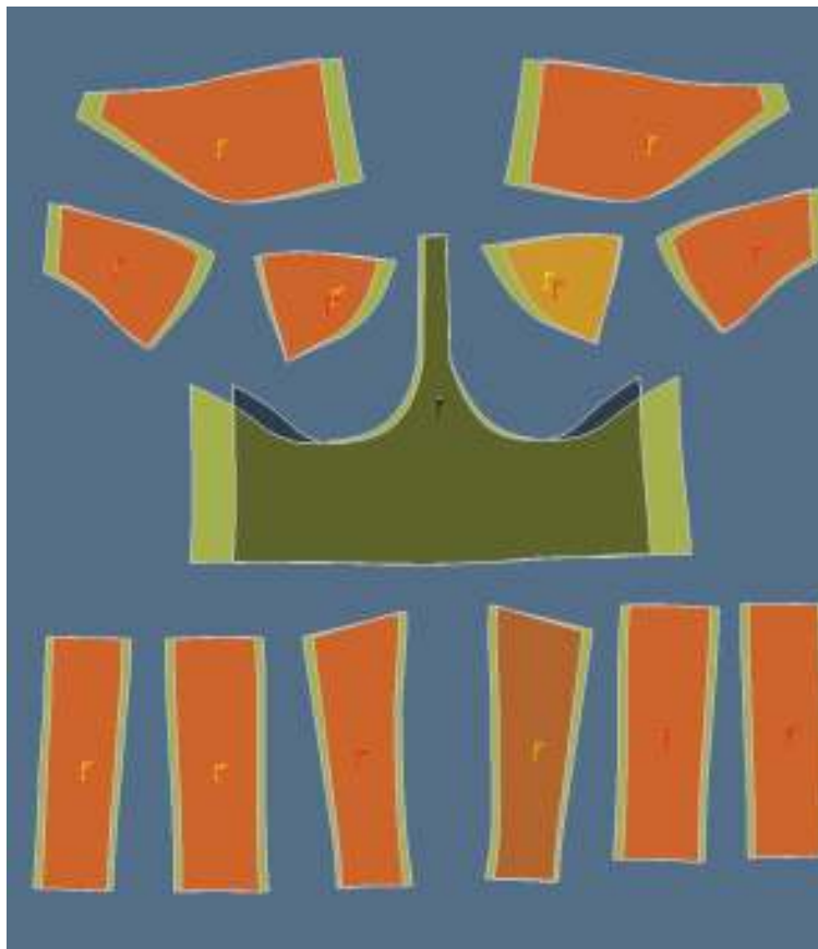
Obr.č. 125: Střih3 porovnání střihu po optimalizaci pro materiál M1(červená) a materiál M2 (žlutá)
