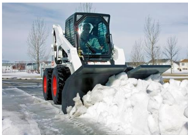
Obr. 11 Nakladač se sněhovým pluhem [32]
