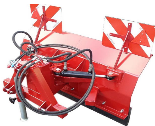
Obr. 6 - Hydraulický systém pluhu [15]
