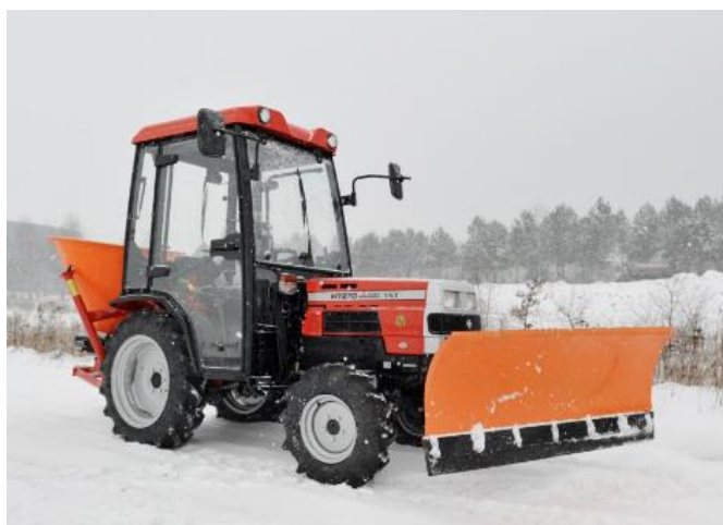
Obr. 9 Kombinované připojení pluhu a rozmetače k malotraktoru [30]
