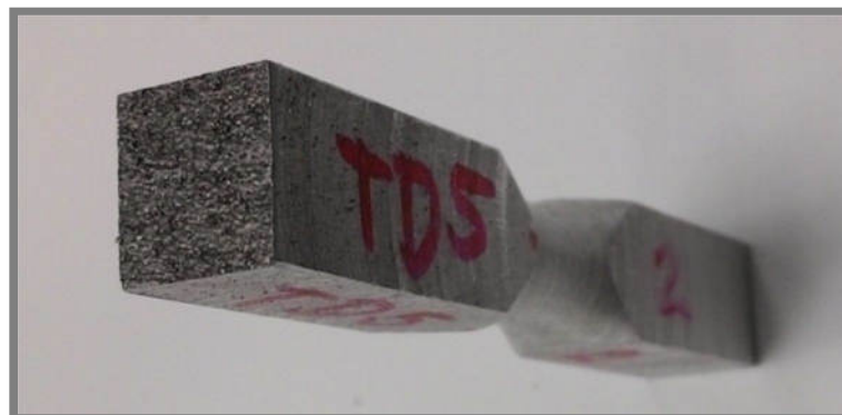
Obr. 4-18 Čelo SLM vzorku se špatnou kvalitou povrchu
