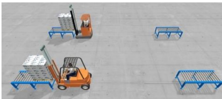
Obr. 3.26 Vysokozdvížený vozík a Reach truck při nakládání palet
