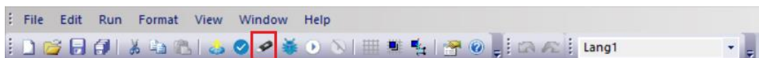
Obrázok 7.5 Lišta programu Panel Builder 600 so zvýraznenou ikonou na vytvorenie súborového balíku pre HMI panel
