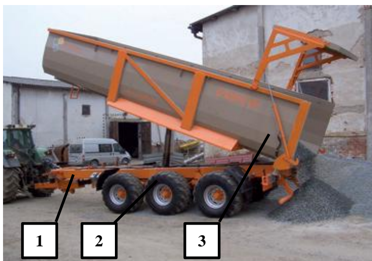
Obrázek 5-13 Podvozek Triton + nástavba BB33: 1. Rám podvozku, 2. Náprava tridem, 3. Vanová korba dozadu sklápěná (4).
