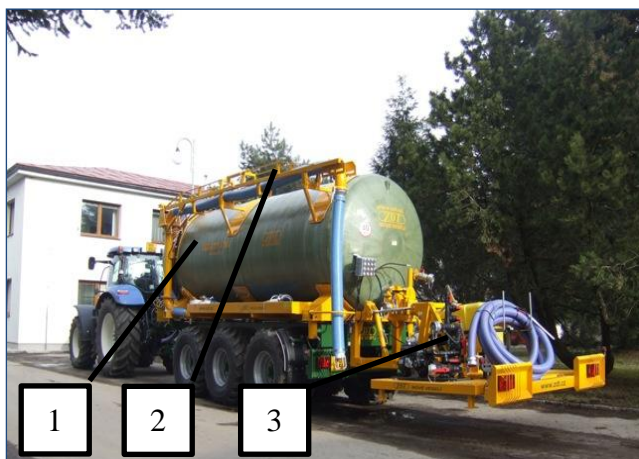
Obrázek 5-5 Mega 25 + cisterna CGS NTF 15: 1. Zinková cisterna, 2. Sací rameno, 3. Míchání (5).
