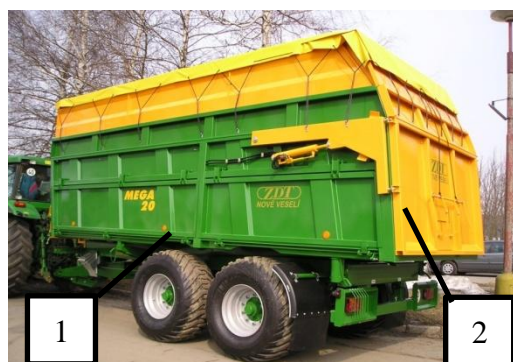
Obrázek 5-3 Mega 20 + dvoustraně sklápěná korba: 1. Otvírací boční stěna, 2. Zadní otvírací čelo (5).
