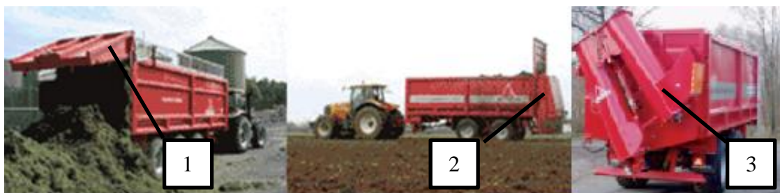
Obrázek 5-21: Systém Shubfix: 1. Zadní klasické čelo, 2. Rozmetací čelo, 3. Překládací šnek (2).
