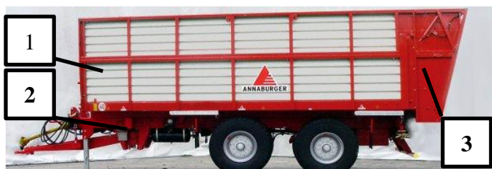
Obrázek 5-16 Senážní korba: 1. Nástavba, 2. Podvozek, 3. Zadní čelo s rozdružovacími válci (10).
