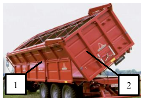
Obrázek 5-14 Kombinovaný sklápěč: 1. Otvíratelná bočnice, 2. Otvíratelné zadní čelo (10).
