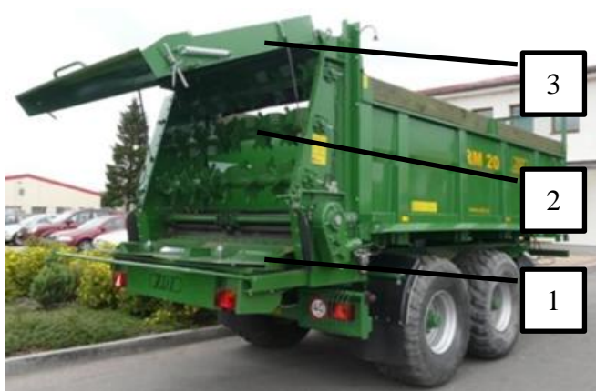
Obrázek 5-4 Mega 20 s rozmetadlem RM 20: 1. Dvukotoučové rozmetací ústrojí, 2. Frézovací válce, 3. Zadní kryt (5).
