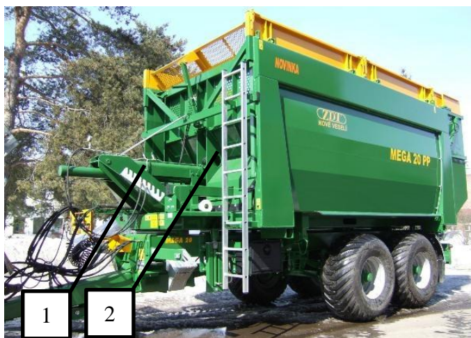
Obrázek 5-6 Mega 20+PP korba: 1. Hydraulické válce, 2. Výtlačný štít (16).
