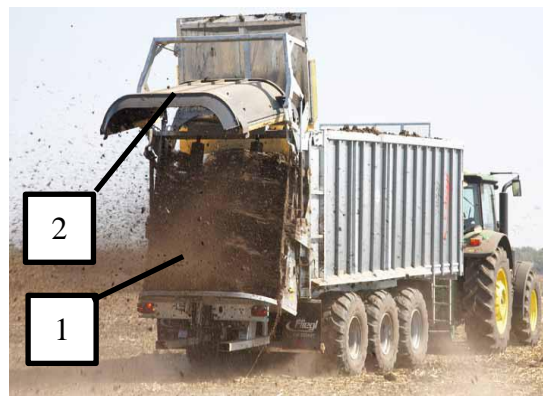
Obrázek 5-11 Rozmetadlo Profi: 1. Rozmetací válce, 2. Kryt (3).
