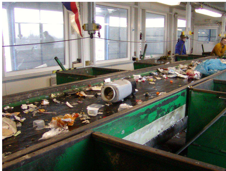
Obrázek č. 11 – Ruční třídění odpadu
