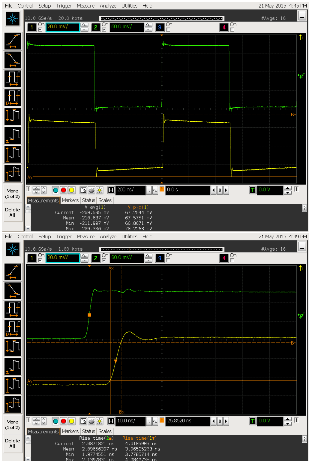
Obr. C.2: (OPA847) Časový průběh při buzení pulzy (nahore) a detail náběžné hrany (dole)
