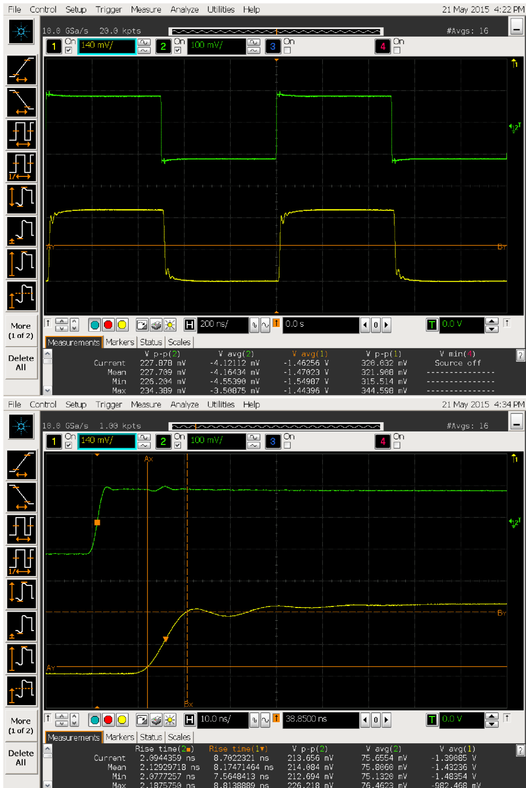
Obr. C.1: (OPA657) Časový průběh při buzení pulzy (nahore) a detail náběžné hrany (dole)
