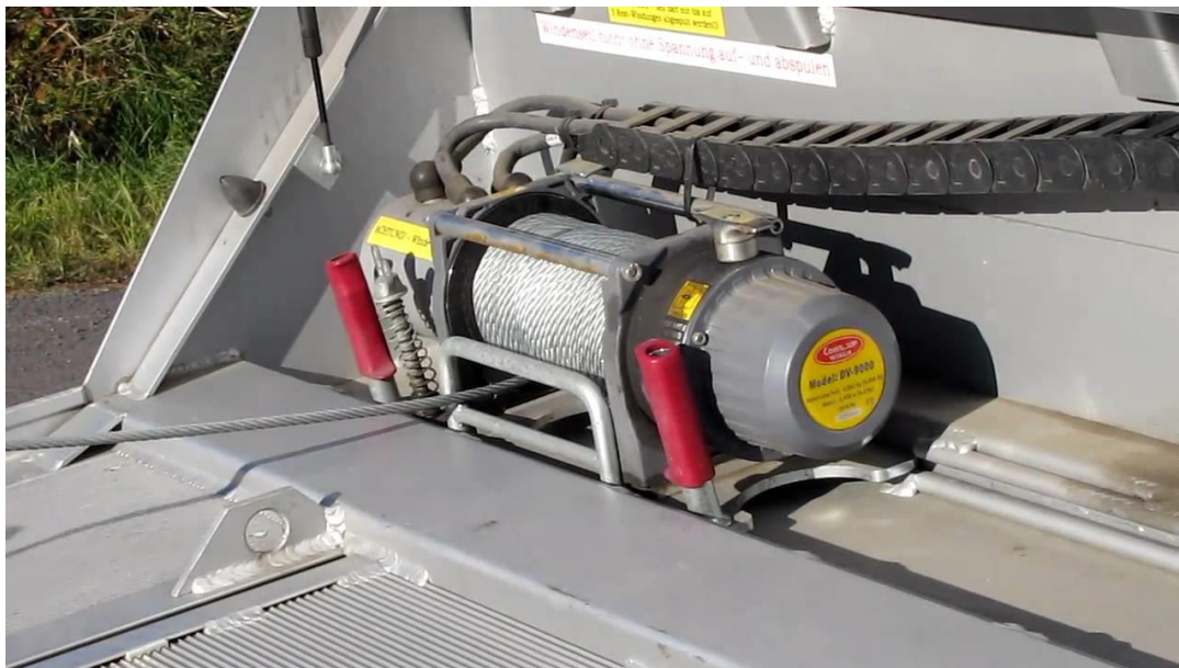
Obr. 4 – Naviják s možností posuvu po plošině na odtahovém vozidle
