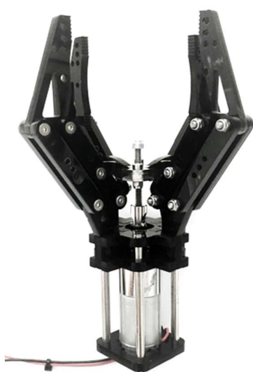
Obrázok 3.17: Koncový efektor so štyrmi článkami vhodný pre lineárny pohon. [19]
