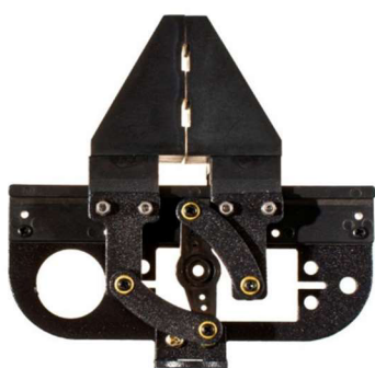
Obrázok 3.15: Efektor s prepákováním [56]. Obrázok 3.16: Efektor s ozubeným prevodom [55].
