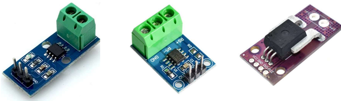
Obrázok 3.37: Prúdové čidlá, zľava: ACS712 [41], MAX471 [42], ACS758LCB [43].
