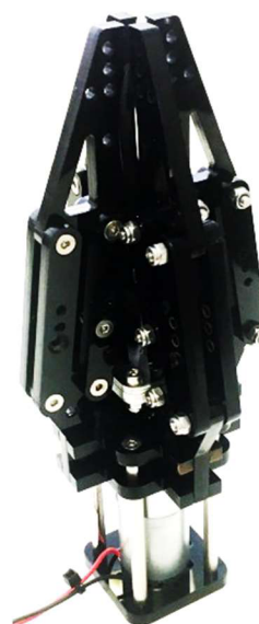
Obrázok 3.17: Koncový efektor so štyrmi článkami vhodný pre lineárny pohon. [19]
