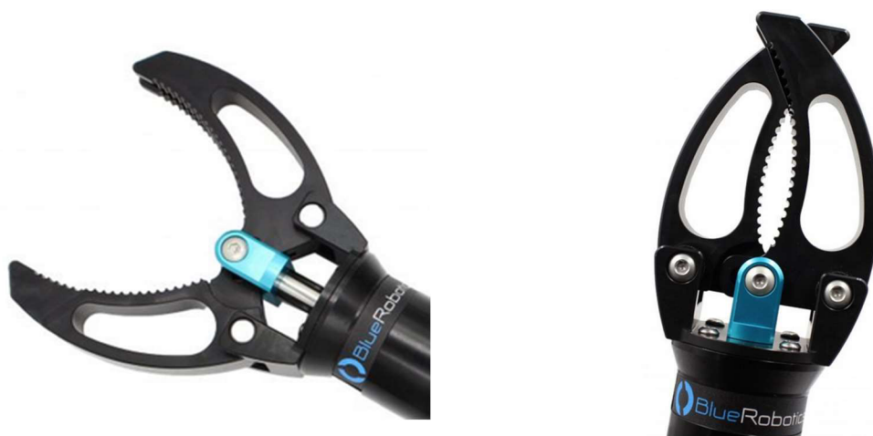
Obrázok 3.18: Jednoduchší koncový efektor vhodný pre lineárny pohon [20].
