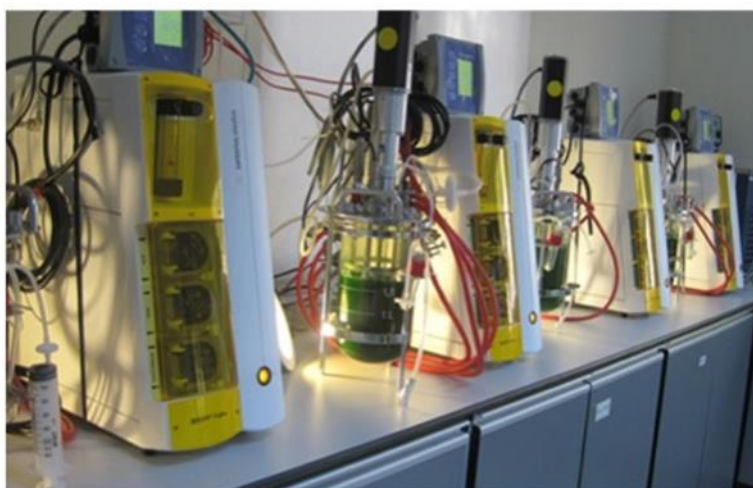
Obrázek 3: Bioreaktory pro produkci Chlorella vulgaris (Kose et al. , 2017)
