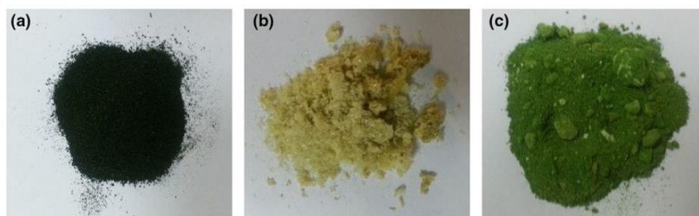
Obrázek 4: Neošetřený vzorek (a), hydrolyzovaná biomasa (b), zbytková buněčná biomasa (c) (Kose et al., 2017)
