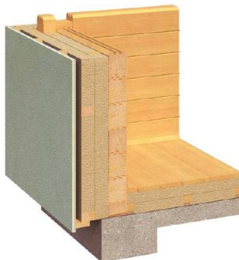
Obr. 6 Obvodová stěna s masivním hranolem ze strany interiéru (LOGHOUSE 2012)
