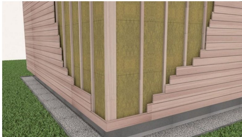
Obr. 14 Skladba stěny s vnějším dřevěným opláštěním (TZBINFO)
