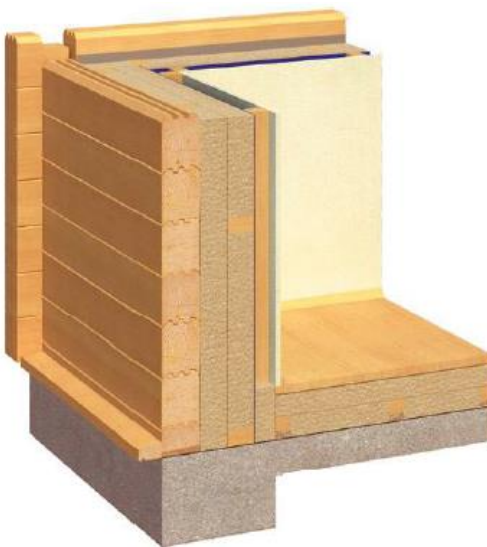
Obr. 7 Obvodová stěna s masivním hranolem ze strany exteriéru (LOGHOUSE 2012)
