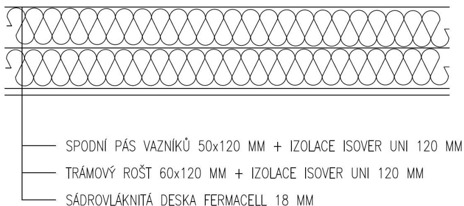
Obr. 18 Schéma skladby stropu
