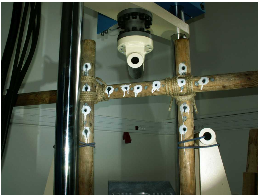
Obr. 60: Detail zkoušené konstrukce (varianta s použitím přírodního lana)
