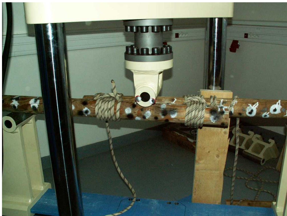
Obr. 71: Detail zkoušené konstrukce (varianta s použitím syntetického lana)
