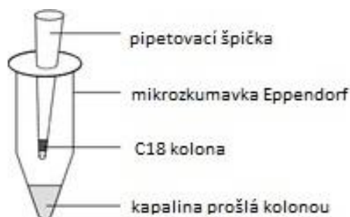
Obr. 9: Připravená „Stage Tips“ kolona pro přečištění peptidové směsi (převzato a upraveno z Spruijt et al. 2013).
