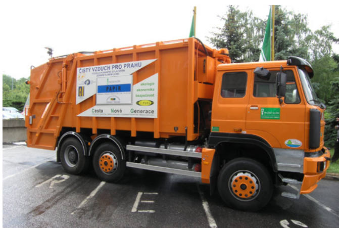
Obr. 5.3 Nákladní vozidlo na CNG [27]
