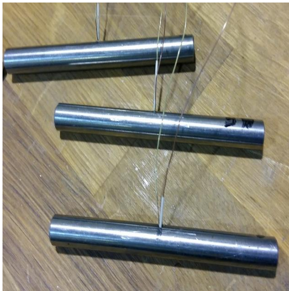
Obr. 3.3 Vzorky s připájenými termočlánky.
