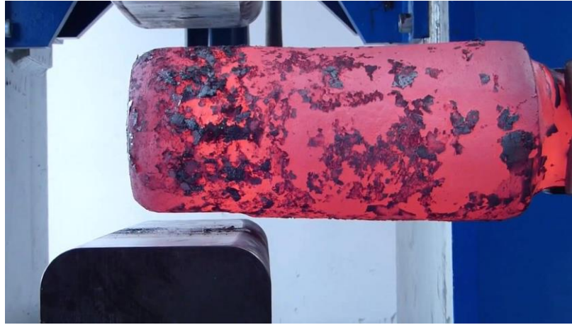
Obr. 2.9 Příklad volného strojního kování na lisu. [13]
