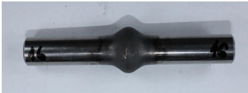
Obr. 3.6 Ukázka vzorku po řízené deformaci (vzorek 16).
