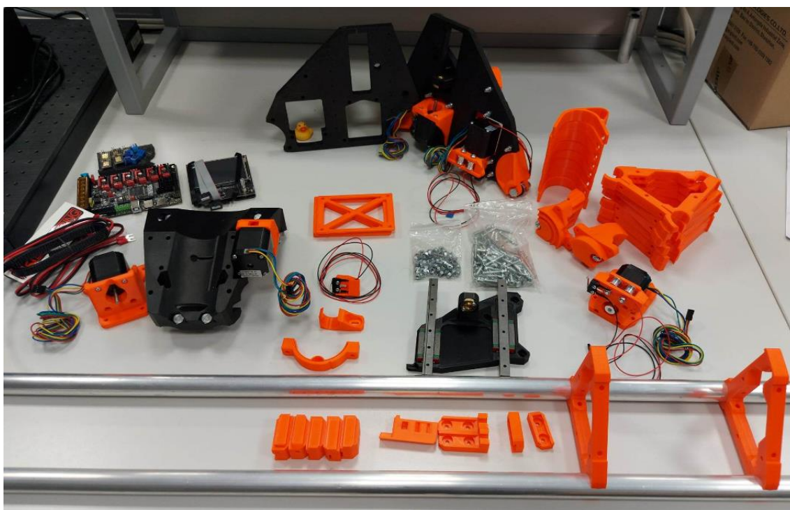
Obrázok 29: Postupné mechanické skladanie LowRideraV3
