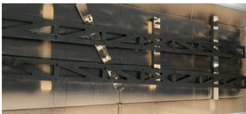
Obrázok 30: Vyrezaná a nastriekaná "výplň" pre os X
