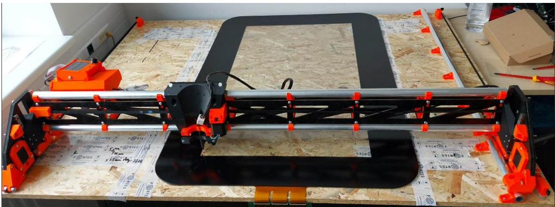
Obrázok 39: LowRiderV3 osadený na doske s pripevneným stylusom a dotykovým panelom so senzorom zo strieborných nanovlákien
