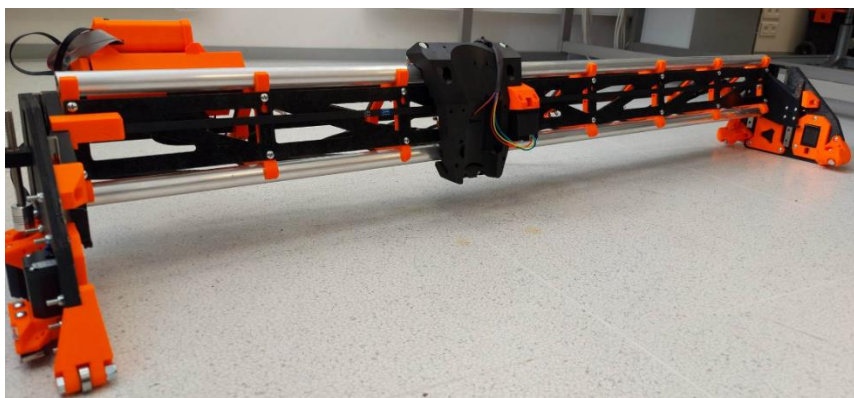
Obrázok 33: Finálna podoba LowRiderV3 s elektrickým zapojením
