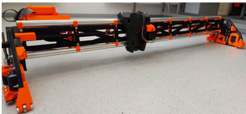
Obrázok 33: Finálna podoba LowRiderV3 s elektrickým zapojením
