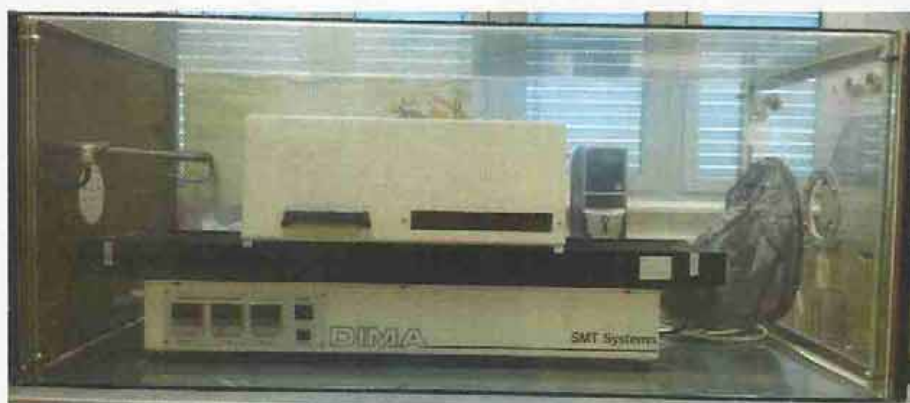
Obr. 19: Průběžná pec ve skleněné komoře
