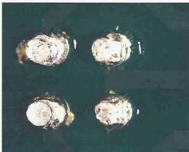
Obr. 25: Vývody na DPS 0,16 °C/s s povrchovou úpravou Ni – Au
