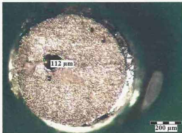
Obr. 35: Vývod na DPS 2,00 °C/s s povrchovou úpravou OSP
