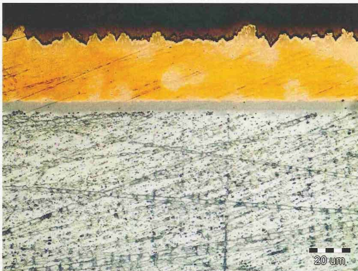
Obr. 45: DPS 6,80 °C/s s povrchovou úpravou Ni – Au
