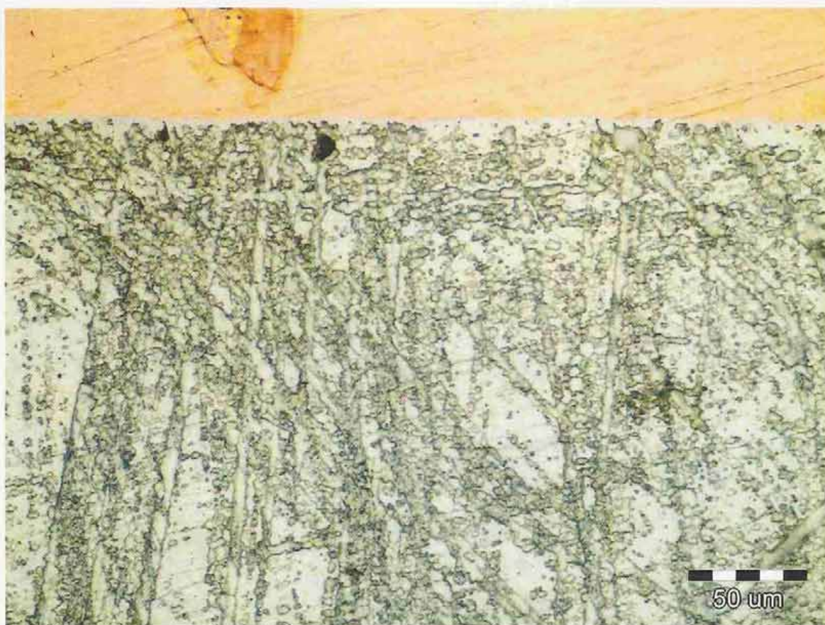
Obr. 42: DPS 6,80 °C/s s povrchovou úpravou OSP
