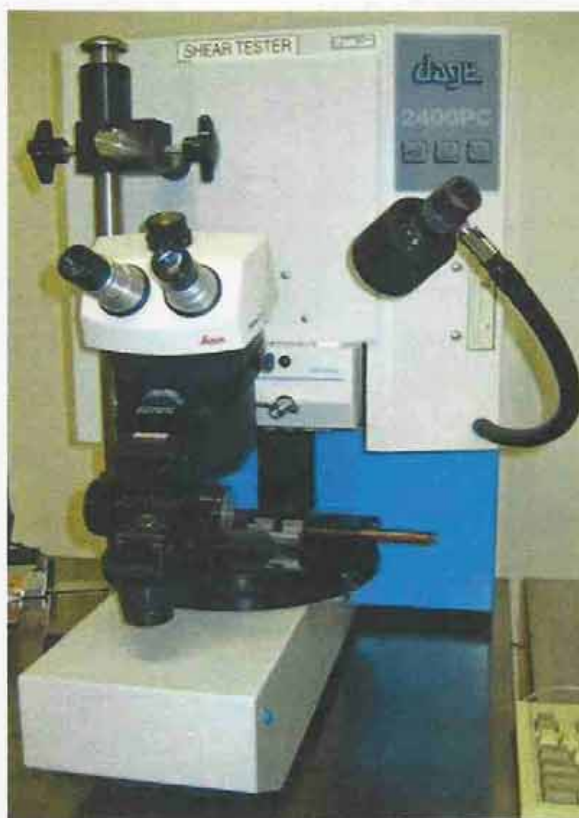
Obr. 15: Zařízení DAGE PC 2400, které umožňuje test stříhem [14]
