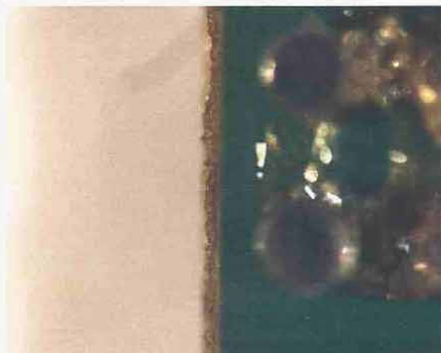
Obr. 30: Hrana BGA4 6,80 °C/s s povrchovou úpravou Ni – Au
