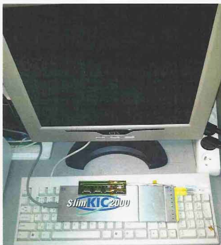
Obr. 20: Zařízení SlimKIC 2000 s počítačem a prototypem na měření teplotního profilu
