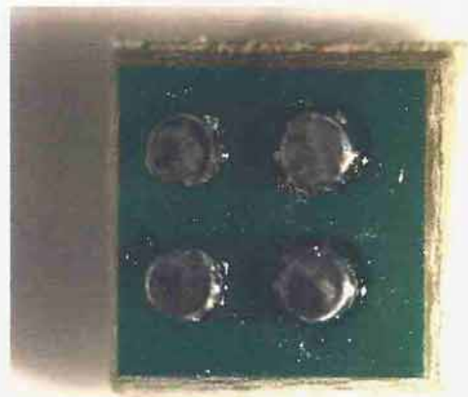
Obr. 32: Vývody na BGA4 2,00 °C/s s povrchovou úpravou Ni – Au
