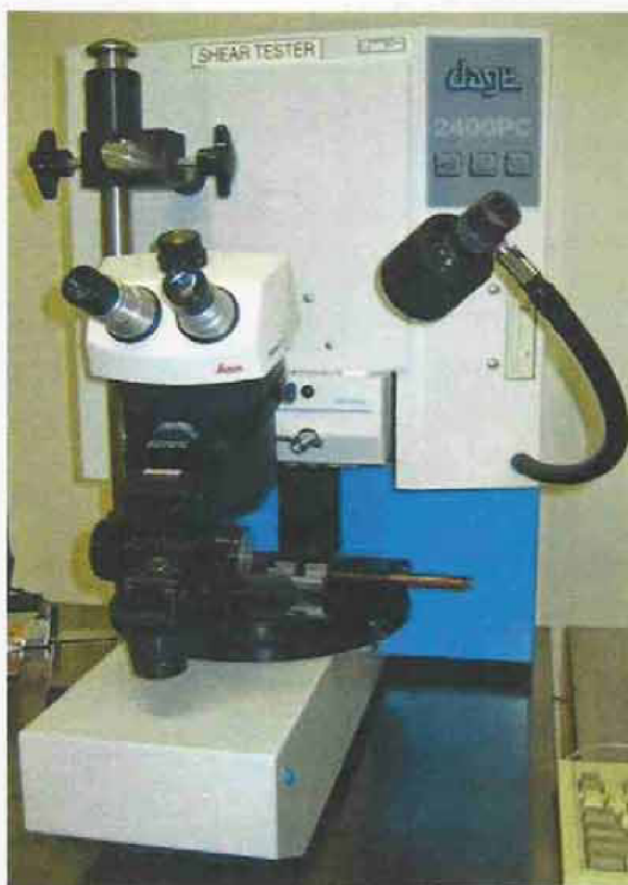
Obr. 15: Zařízení DAGE PC 2400, které umožňuje test stříhem [14]
