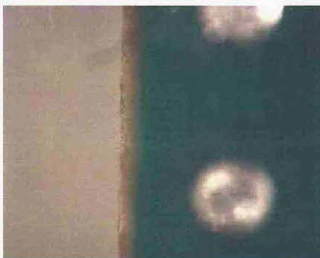
Obr. 27: Hrana BGA4 0,16 °C/s s povrchovou úpravou Ni – Au
