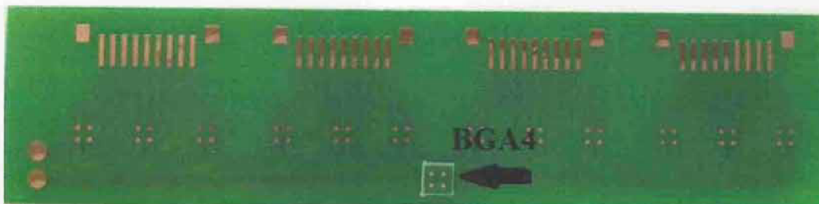
Obr. 17: Neosazená DPS s imitací součástky BGA4 s povrchovou úpravou OSP
