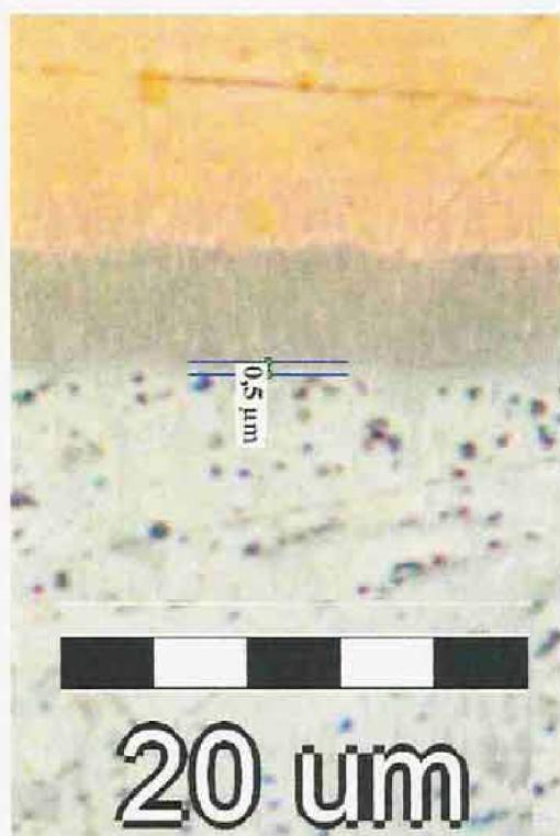
Obr. 40: DPS 2,00 °C/s s povrchovou úpravou Ni – Au – změřená tloušťka IMC vrstvy je 0,5 μm
