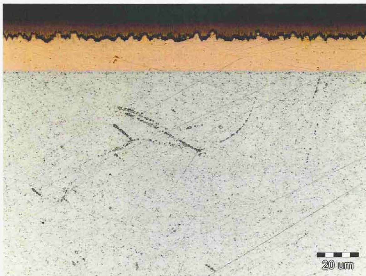
Obr. 44: DPS 0,16 °C/s s povrchovou úpravou OSP
