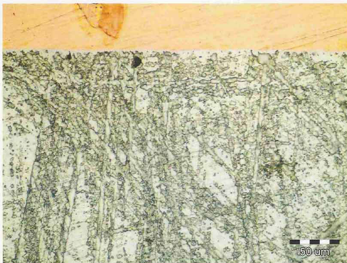
Obr. 42: DPS 6,80 °C/s s povrchovou úpravou OSP
