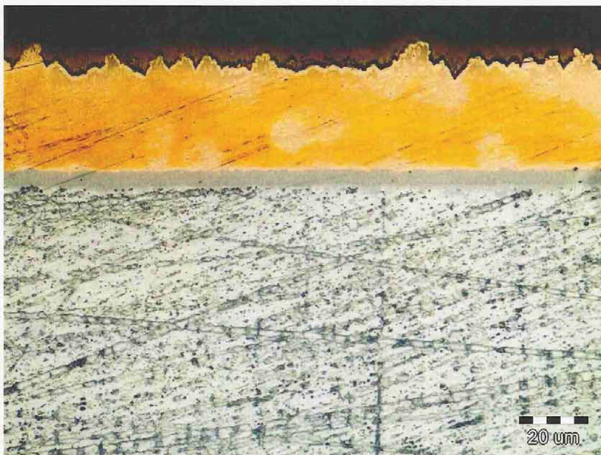
Obr. 45: DPS 6,80 °C/s s povrchovou úpravou Ni – Au
