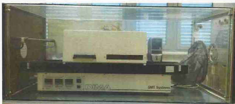
Obr. 19: Průběžná pec ve skleněné komoře
