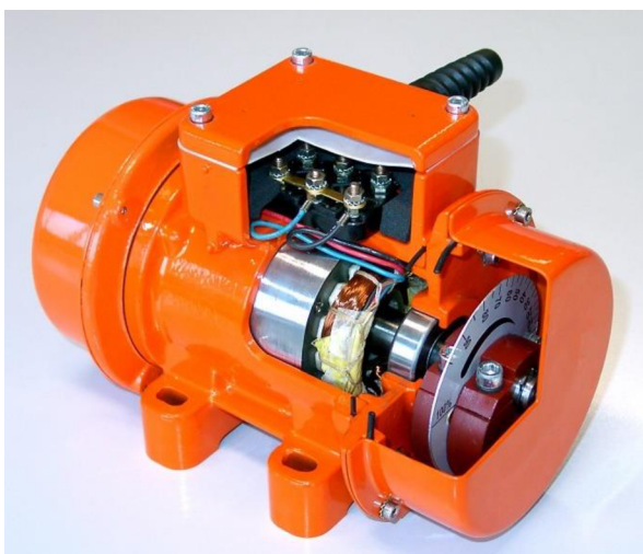
Obr. 2 Elektromagnetický vibrátor v řezu [8]
