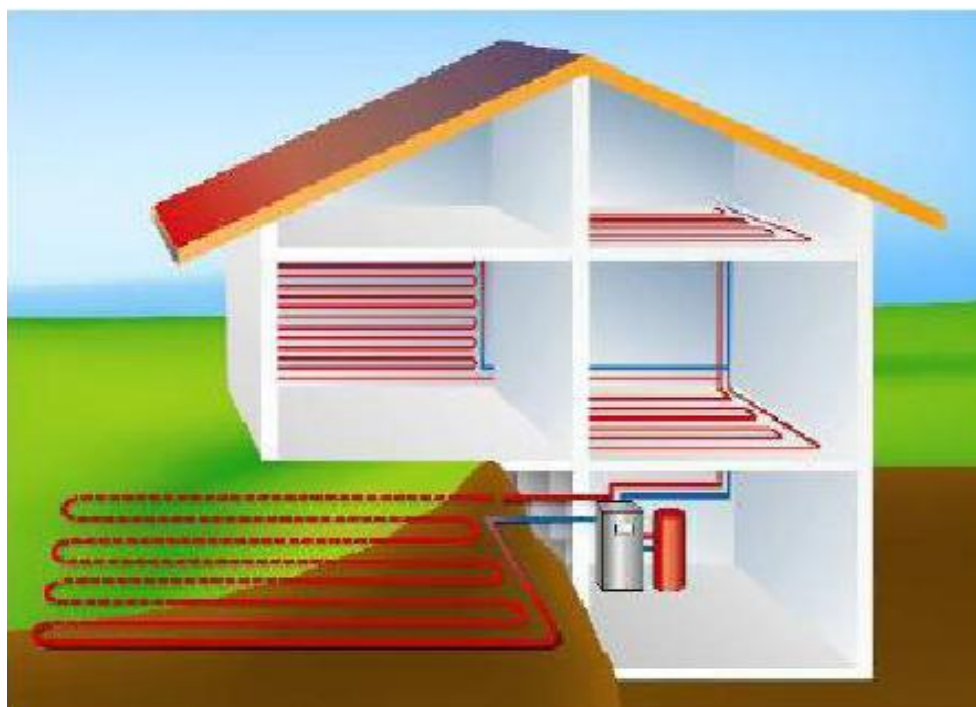
Obr. č. 6.: Funkční schéma systému země / voda (BÖSWARTH & KOL. 2006)
